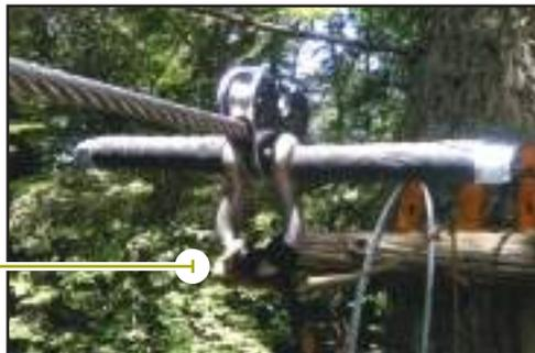
Le modèle de poulie de marque Petzl « Tandem Speed » sur la photo ci-dessous est le plus populaire dans les parcours aériens. Le diamètre de la corde ou du câble doit cependant être inférieur à 13 mm (1/2 po). Notez que la « Tandem Speed » est sur roulement à billes et très rapide. Elle est prévue pour des tyroliennes aux pentes et tensions calibrées. La « Tandem Cable » sur coussinets est moins rapide et fonctionne aussi bien avec des câbles d'acier qu'avec des cordes.
